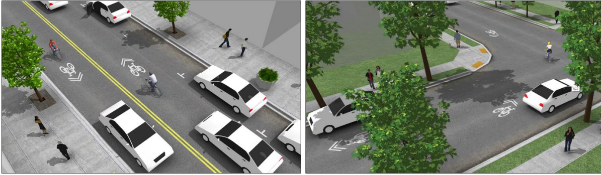
Figura 7. Disposición de “sharrows” en la vía.
